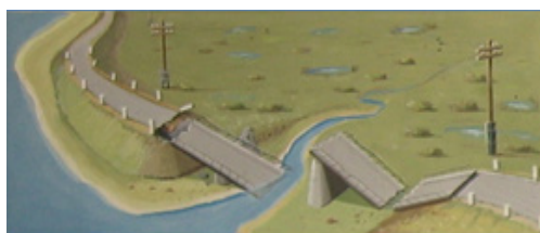
Зураг 2. Тэсрэх бодисын цэнэгийг байрлуулан гүүрийн тулгуур баганыг тэслэн гүүрний дам нуруу болон зорчих хэсэгт эвдрэл учруулсан байдал
