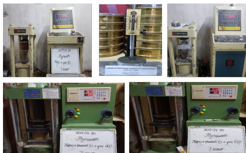
Зураг 5. Цементээр бэхжүүлсэн суурийн шахалтын бат бэх тодорхойлох туршилт
