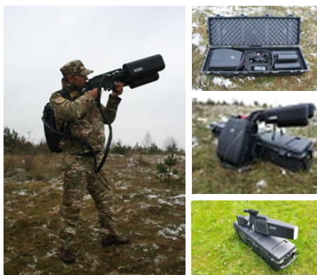
8 дугаар зураг. Мультикоптерын эсрэг тэмцэл явуулах радиоэлектронон буу "гроза-Р"
