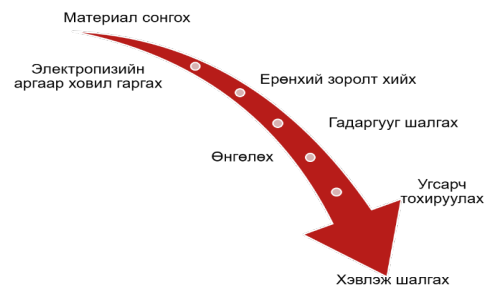
6 дугаар зураг. Хуванцар материалын хэв үйлдвэрлэх технологи
